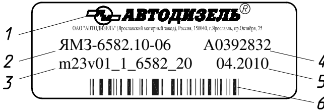
Рис. 27. Наклейка на ЭБУ М230.Е3 двигателя ЯМЗ-6582.10-06
