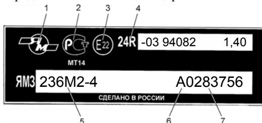
Рис. 32а. Заводская табличка двигателя ЯМЗ-236М2-4
