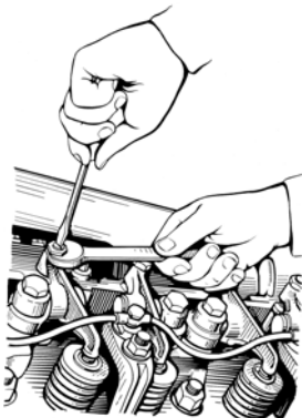
Рис. 18. Отвертывание контргайки регулировочного винта
