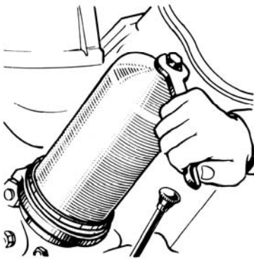
Рис. 53. Отвертывание колпака фильтра
