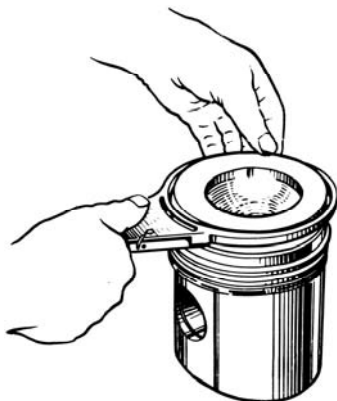
Рис. 80. Снятие и надевание поршневых колец на поршень
