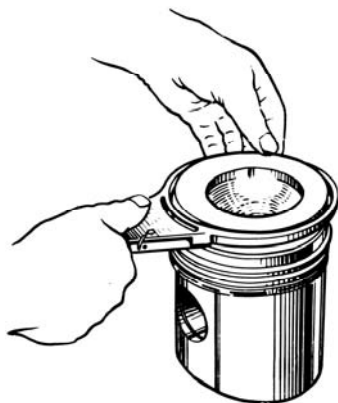
Рис. 79. Щипцы для снятия и надевания поршневых колец: 1 – поршневое кольцо; 2 – губки щипцов; 3 – рукоятка
