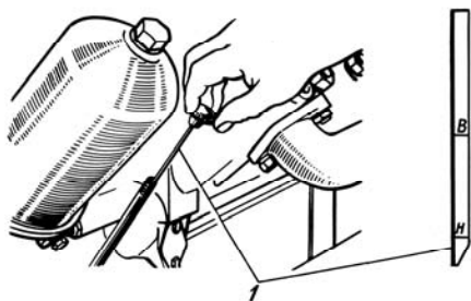
Рис. 60. Проверка уровня масла в картере двигателя: 1 – указатель уровня масла.
