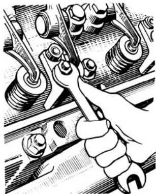
Рис. 81. Отвертывание гайки скобы крепления форсунки
