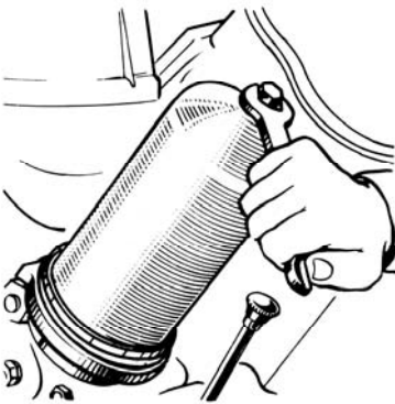
Рис. 61. Отвертывание колпака фильтра
